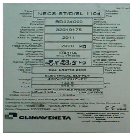
Caractéristiques techniques des Groupes de Production d'eau glacée existante :
